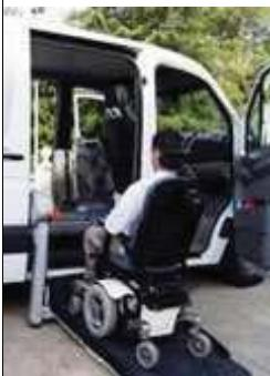
necesarias para permitir que una persona con graves problemas de movilidad pueda conducirlo con total efectividad y seguridad. Además, se ha instalado una rampa que permite al usuario acceder con su silla de ruedas hasta el puesto de conducción, lo que implica la automatización de la puerta de acceso, una plataforma elevadora y un anclaje automático de la silla. En definitiva, se trata de hacer la vida un poco más fácil a los discapacitados.
